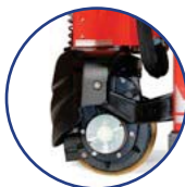
Motor tracción 0,65 kW Rueda Ø210x70mm
