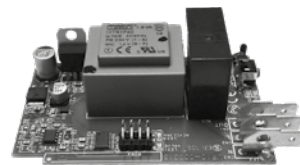
Controlador de presión electrónico Electronic pressure controller Contrôleur de pression électronique
