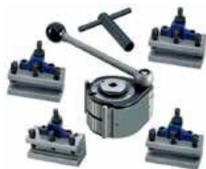
Torreta de cambio rápido montada de serie
