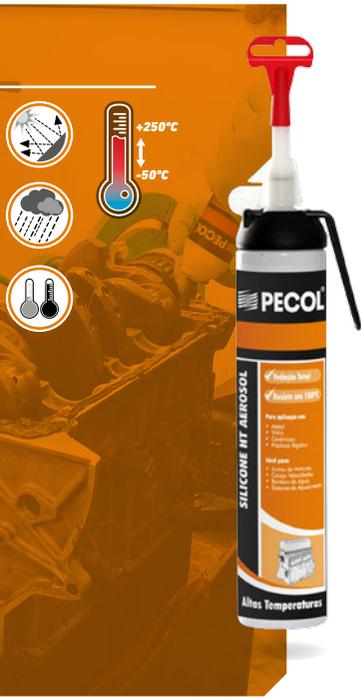
Silicone Neutro Oxime monocomponente para vedações e selagens em juntas sujeitas a elevadas temperaturas. Indicado para colagem e selagem em locais que exijam uma grande resistência a óleos e gorduras. Boa adesão em aço, alumínio, vidro, cerâmica e muitos outros materiais. Cura à temperatura ambiente sob a ação da humidade atmosférica conferindo uma flexibilidade permanente ao cordão de silicone.
