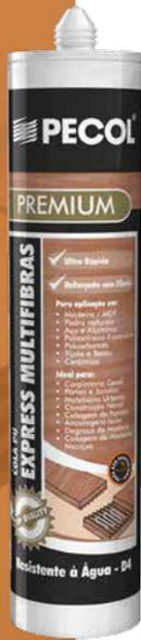
Cola estrutural à base de PU reforçada com fibra de vidro com elevado poder de colagem e secagem rápida. Excelente resistência às condições atmosféricas, variações térmicas e humidade. Indicado para colagem de uniões em madeira, alumínio, pedras naturais, cerâmica, metal, poliuretano, expostas à intempérie. De acordo com a norma (DIN EN 204 D4) e (DIN 14257 D4 standard).
