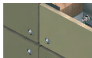
Fibrocemento sobre madera
