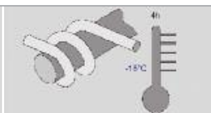
Test de Flexibilidad s/ CSA-C 22,2 Nr. 227, 3-M91 Flexibility test CSA-C 22,2 No. 227, 3-M91
