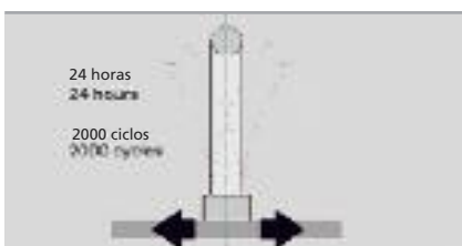
Test de Vibración s/ UL 514 B Vibration test UL 514 B
