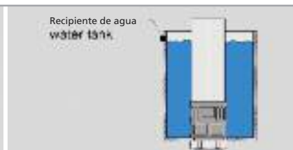
Índice de protección IP según norma 1014 Flexa IP protection class test acc. to Flexa norm 1014
